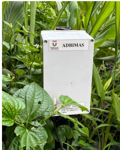
Gambar 1. Instalasi perangkat IoT monitoring kelembapan tanah pada lahan perkebunan Desa Wareng.
