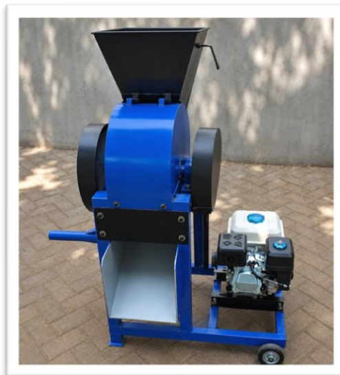
Gambar 3. Mesin giling sampah organik yang diimplementasikan pada Garda Pangan
